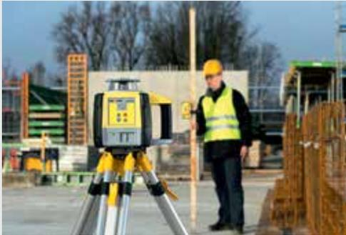
Недорогой и простой в управлении ротационный лазерный нивелир. С прочным корпусом и простым интерфейсом, этот прибор обладает всем необходимым набором функций для ежедневного использования.
