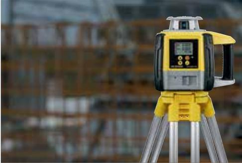
Сочетание надежности основы Zone 40 Н с простотой использования и возможностью цифрового ввода уклона делает эту модель более гибкой в использовании, например, он позволяет задавать уклоны в полуавтоматическом режиме.
